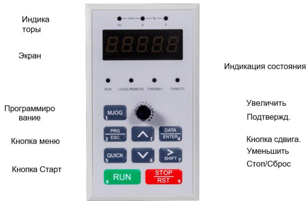
Рис. 4-3 СХЕМА СВЕТОДИОДНОЙ ПАНЕЛИ УПРАВЛЕНИЯ
