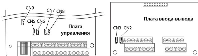
Рисунок 4-5 Расположение перемычек
