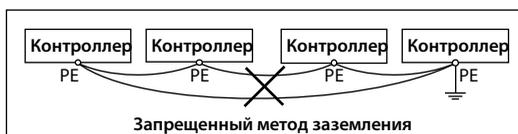
Рисунок 4-33 Запрещенный метод заземления
