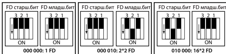
Рисунок 4-15 Частотное разделение платы интерфейса энкодера
