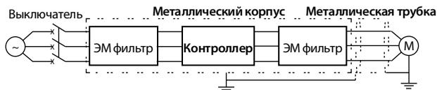
Рисунок 4-34 Противодействие радиочастотным помехам
