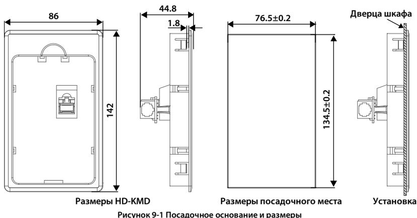
Рисунок 9-1 Посадочное основание и размеры
