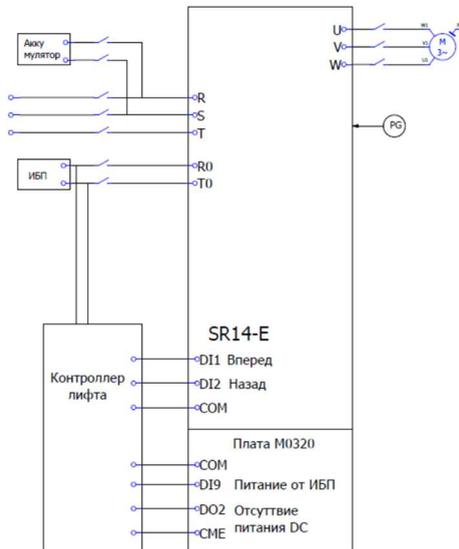
0-6 СХЕМА ПОДКЛЮЧЕНИЯ ПЧ ПРИ ПИТАНИИ ОТ РЕЗЕРВНОГО ИСТОЧНИКА ПИТАНИЯ
