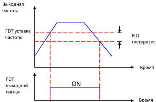
**0-9 ФОРМИРОВАНИЕ СИГНАЛА ОПРЕДЕЛЕНИЯ ЧАСТОТЫ**
