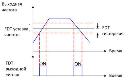
**0-10 ФОРМИРОВАНИЕ СИГНАЛА ОПРЕДЕЛЕНИЯ ЧАСТОТЫ ПРИ FC-08 НЕ РАВНОМУ НУЛЮ**
