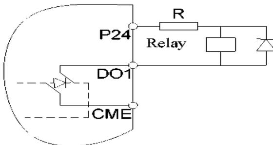
Транзисторные выходы DO1, DO2 также могут запитываться от внешнего источника питания и поддерживают подключение NPN или PNP. При подключении реле к дискретному выходу необходимо установить обратный диод, для исключения пробоя транзистора в цепи дискретного выхода.
