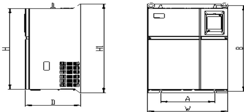
SR14-EN Преобразователь (18.5кВт~45кВт) внешний вид и габаритные размеры
