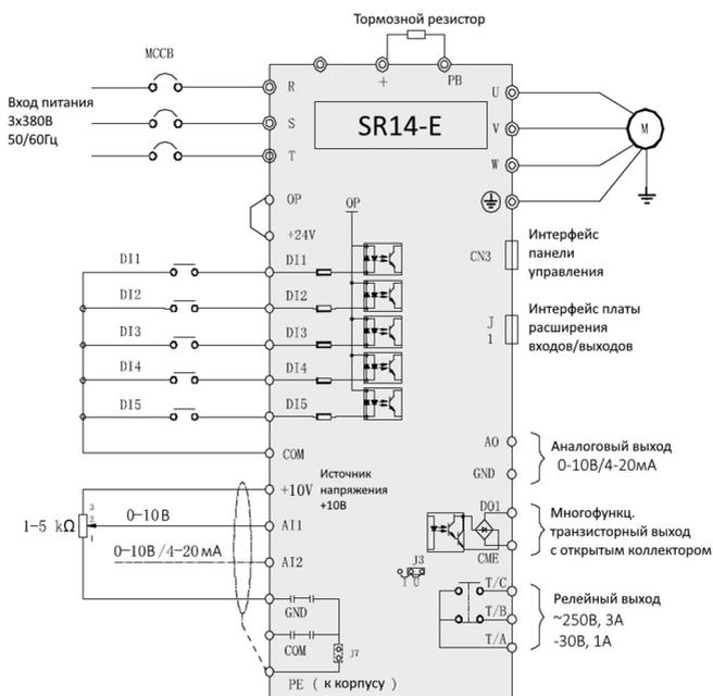
0-4 ВНЕШНИЕ ПРИСОЕДИНЕНИЯ К ЧАСТОТНОМУ ПРЕОБРАЗОВАТЕЛЮ (БАЗОВАЯ ВЕРСИЯ)
