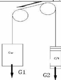
Уставка на допустимое рассогласование моментом представляет собой процент от разности между весом кабины лифта и противовеса. Если G1 кабина без нагрузки, а G2 противовес, тогда фактическая разность G3 и является в процентном соотношении допустимым рассогласованием для пред управления моментом  $F3-10 = (G2-G1) / G3$ .
