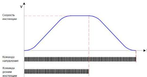
Если сигнал направления снимается раньше, то останов двигателя происходит мгновенно. (Как показано на следующем рисунке, время торможения может быть установлено очень малым, например, 1 сек, таким образом, может быть обеспечена практически мгновенная остановка).
