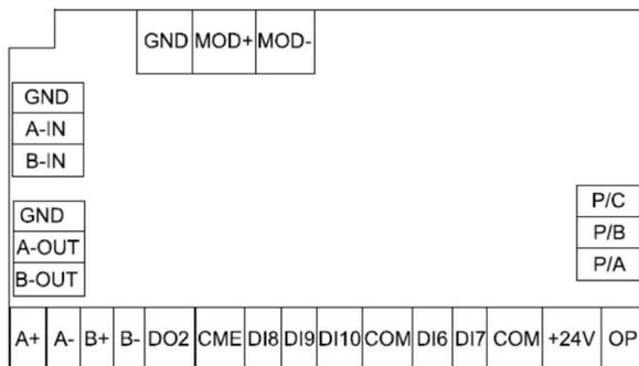
**0-8 КЛЕММЫ ПОДКЛЮЧЕНИЯ ПЛАТЫ РАСШИРЕНИЯ ВХОДОВ/ВЫХОДОВ**
