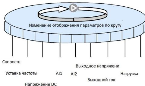
LED дисплей может отображать различные параметры частотного преобразователя в зависимости от его режима (работа, ожидание, авария, настройка). Для настройки отображения параметров в режиме – работа – перейдите в пункт меню F8-01 (Отображение параметров в режиме работы) и F8-02 (отображение параметров в режиме останова (ожидания)). При нажатии кнопки «Сдвиг» - «>>» возможно циклическое отображение параметров в режиме работы или останова.
