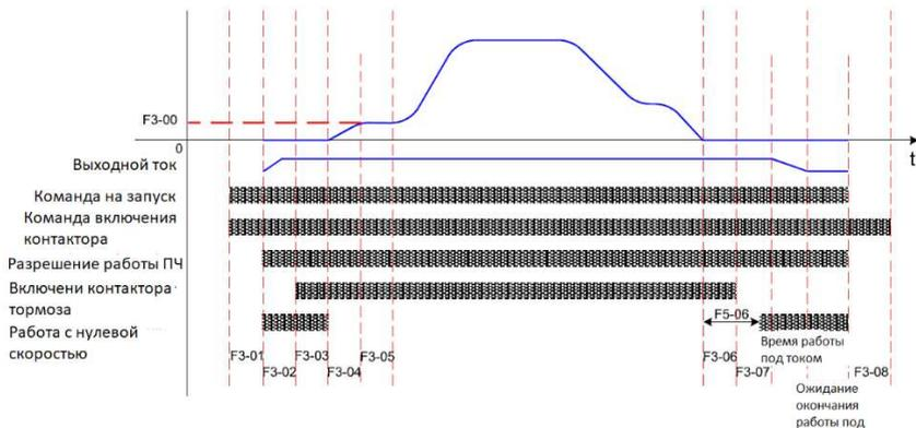
**0-2 ЦИКЛ РАБОТЫ ЧАСТОТНОГО ПРЕОБРАЗОВАТЕЛЯ (ПОСЛЕДОВАТЕЛЬНОСТЬ ФОРМИРОВАНИЯ СИГНАЛОВ)**
