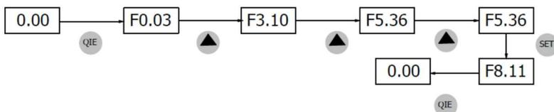
*Примечание:* Нажмите кнопку «PRG» находясь в кратком меню при отображении параметр мигает, нажмите «ENTER», параметр будет удален из меню при окончании мигания надписи. При нажатии кнопки «QUICK» удаление параметра возможно, после окончания мигания надписи и появления надписи «NULL», это означает что операция удаления окончена и параметры изменены.
