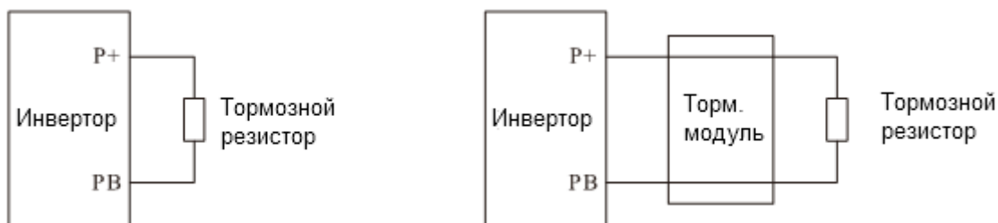
Рис. 2-8 Подключение тормозного модуля и резистора
