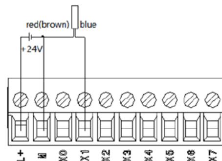
12 Пример подключения датчика NPN по двухпроводной схеме
