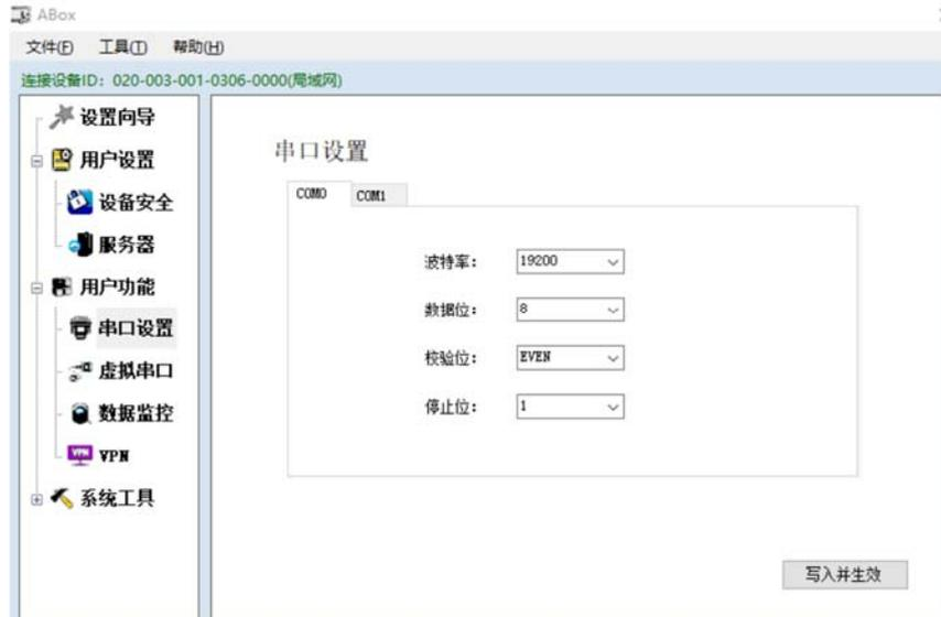
Подключите ABOX к инструменту конфигурации, нажмите пользовательскую функцию «виртуальный последовательный порт», выберите незанятый com-порт ABOX и ПК, нажмите запустить виртуальный последовательный порт.
