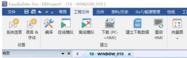
После завершения компиляции установите IP-адрес HMI на 192.168.1.2 00
