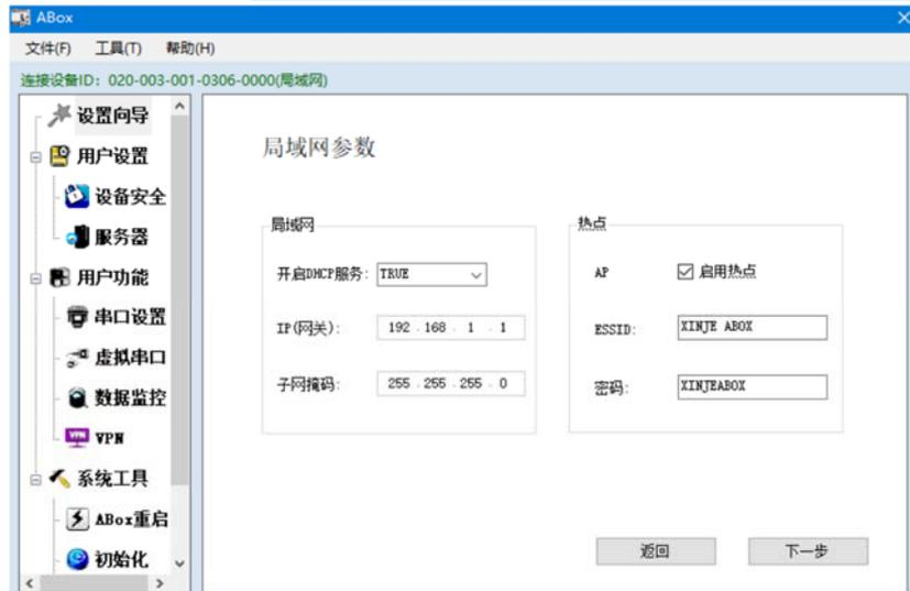
Сохраните IP-адрес Ethernet-порта ПЛК, для которого требуется реализовать VPN шлюз, IP-адрес ПЛК должен находиться в том же сегменте АВОХ, в качестве примера возьмите шлюз по умолчанию, IP-адрес ПЛК — 192.168.1.XX XX в диапазоне 2–251) . Настройки серии XINJE XDE показаны ниже:
